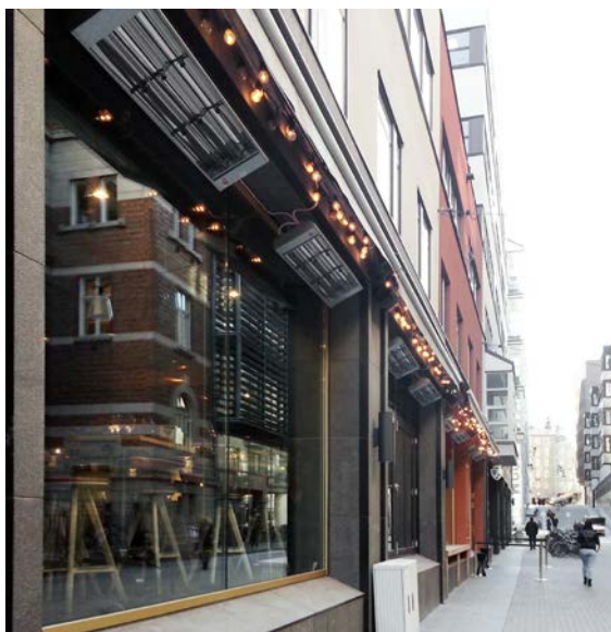
Der IR-Wärmestrahler kann in unterschiedlichen Winkeln montiert werden, um die Wärme dorthin zu richten, wo sie benötigt wird. Außenheizungen sollten unter dem Dach platziert werden.
